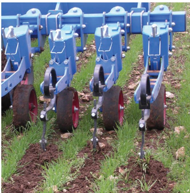
Binage de céréales guidé par satellites
