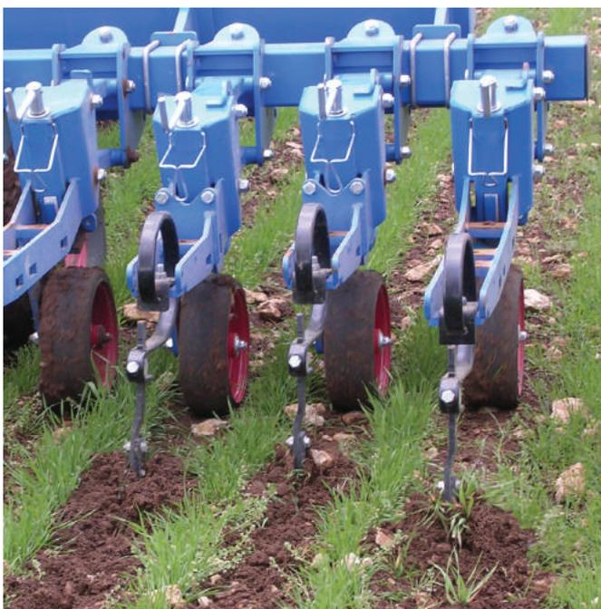
Binage de céréales guidé par satellites
