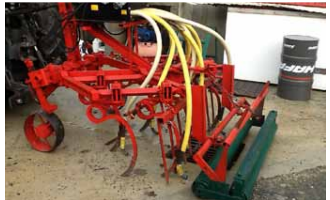
Semoir Delimbe T15 monté sur cultivateur
