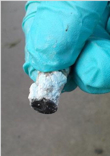
Photo n° 2 : Filtre de buse colmaté
