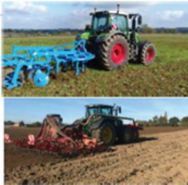
\* Implantation de la culture avec le passage de deux matériels travaillant superficiellement le sol pour avoir un lit de semence fin et homogène \*
