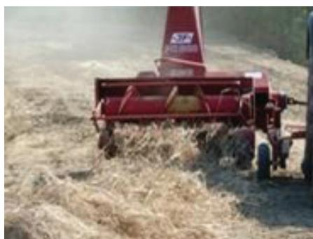
FIGURE 1 : ENSILEUSE À ROTOR CENTRAL
