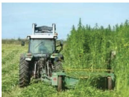
FIGURE 2 : FAUCHEUSE CONDITIONNEUSE
