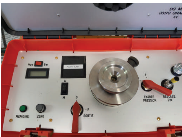
Mesure de potentiel hydrique des tiges avec une chambre à pression, le 25/08/2023
