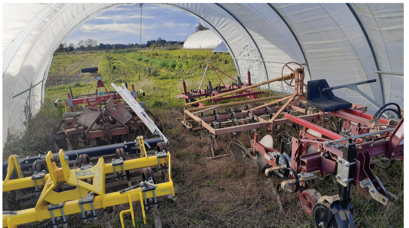
Exemple partiel de parc matériel attelé des typologies « mécanisées » : bineuse guidée, déchaumeur à dents et à disques, vibroculteurs, dérouleuse plastique.
