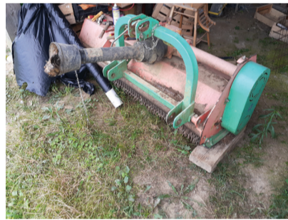
Exemple de broyeur à couteau d'occasion ne broyant pas finement. La mise en place d'un capot à terme améliorera la finesse du broyage et diminuera les difficultés liées aux destructions tardives
