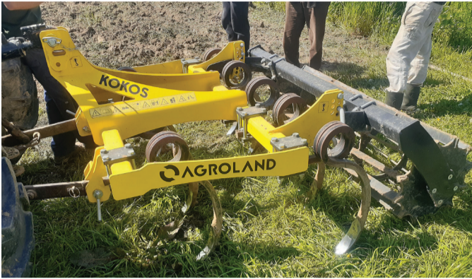
Exemple de déchaumeur à dent (amélioration potentielle identifiée pour le recouplement total des différentes dents pas tout à fait effectif sur cet outil)
