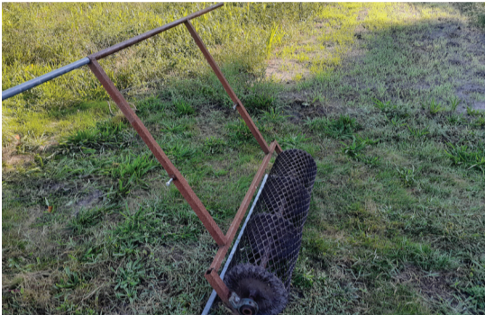
Rouleau non attelé auto construit pour rappuyage du semis (petites graines, sol léger avec irrigation si besoin)
