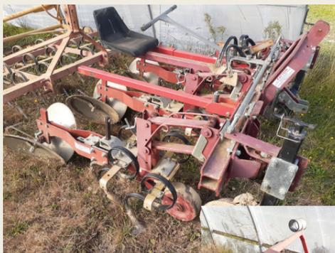
Exemple de bineuse butteuse guidée 2 rangs
