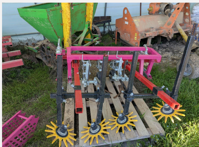
Doigts de binage pour un travail au plus près du rang
