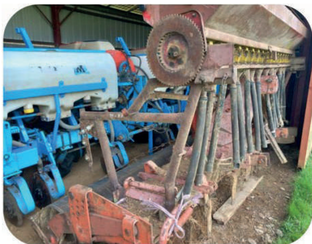
Combiné de semis avec rouleau utilisé pour semer un trèfle en même temps que le blé à l'automne dans les Pyrénées-Atlantiques
