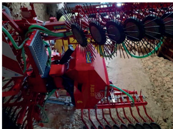
Semoir sur roto-étrille utilisé pour semer une prairie temporaire dans une parcelle de blé bio, au printemps, dans le Jura
